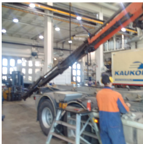
Kuva 2.1: Autonosturin, katonosturin, ja trukin yhteisvaikutuksena voimme vaihtaa liukupalat.
