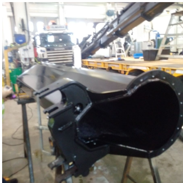
Kuva 1.2: Isomman puoleinen pätkä nosturia pukilla pinnan tarkastusta varten.
