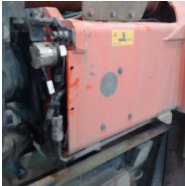
Kuva 2.4: Pari anturille menevää johtoa pitäisi saada irti.
